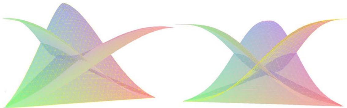
Figur 13.7: Vi ser de tre komponentene til en Beta-funksjon i homogene barysentriske koordinater, tre 1.-ordensfunksjoner til venstre og tre 2.-ordensfunksjoner til høyre.
