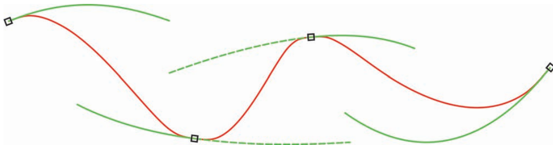
Figur 8.6: En blendingsplinekurve plottet i rødt, og med fire lokale kurver plottet i grønt. Den resulterende kurven er en blanding av dens lokale kurver, hvor de er blendet med en B-funksjonen. Den resulterende kurven interpolerer verdien og alle deriverte til hver av de tilstøtende lokale kurver i "midt"skjøten.
